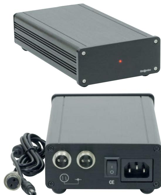
*L'alimentatore stabilizzato lineare opzionale promette secondo il costruttore prestazioni migliori. È basato su un trasformatore toroidale e ha il filtro EMI antidisturbi in ingresso e CLC in uscita.*
